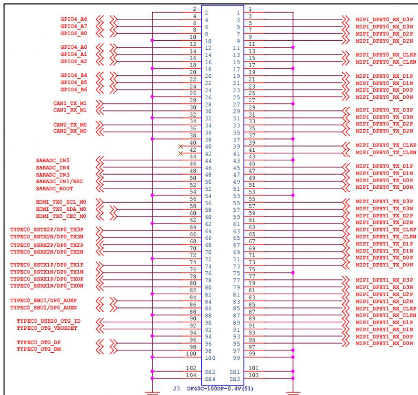
图 4.6-2 J3 连接器原理图
